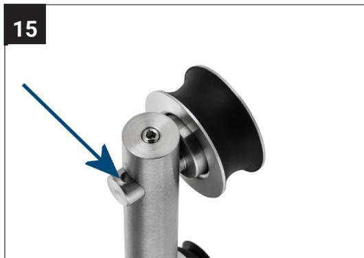
Der Laufwagen ist über einen Exzenter verstellbar, wodurch Sie die Schiebetür anheben können, wenn sie am Boden schleift.
