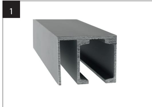
Die Laufschiene verfügt über zwei Führungskanäle. Der hintere Kanal dient der Aufnahme des Festteils und der vordere Kanal dem des Laufwagens.
