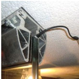
4. Schließen Sie nun den Trafo an die Steckerverbindung an. Achtung: Der Trafo ist nur für den Gebrauch im Trockenen bestimmt.
