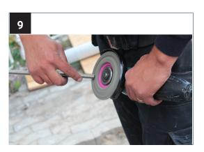
Entgranten Sie die Schnittstellen der Gewindestange mit der Schleifmaschine.
