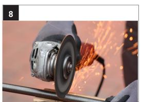
Schneiden Sie die Gewindestangen auf die benötigte Länge zu.
