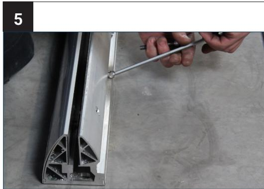
Ziehen Sie die Abdeckung vom Profil und Schrauben den Adapter ab.
