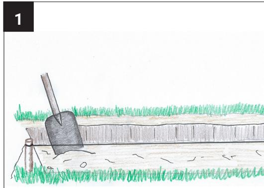
Spannen Sie eine Schnur entlang des geplanten Verlaufs. Heben Sie entsprechend dieser Flucht die Fundamentgrube aus. Die Tiefe und Breite richtet sich nach dem individuellen Aufbau Ihres Streifenfundamentes, beispielsweise inklusive Drainage oder Bewehrungskorb.
