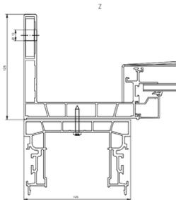
Auf dem fertigen Fußboden ist ein Verkleben des Seitenteilrahmes ohne Verschraubung eine Alternative. Ist ein Fundament vorhanden, kann ein innen geführtes Rechteckrohr nach unten verschoben und durch einen Bodenwürfel verschraubt werden. Das untere Rahmenprofil ist entsprechend aufgefräst. Durch diese vordere Befestigung des Seitenteils auf einem druckfesten Fundament werden Wind- und Schneelasten sicher aufgenommen.
