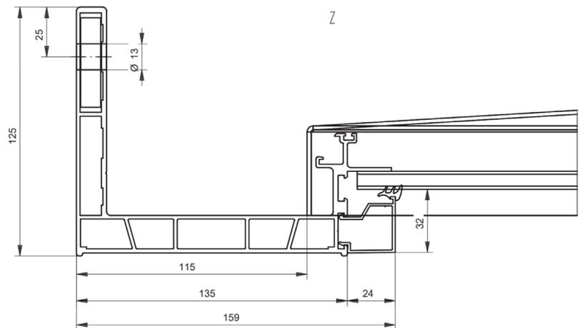
Das 4-seitige Rahmen-Rinnenprofil ist an der Wandseite bereits mit 13 mm vorgebohrt. Die Verschraubung/Befestigung hat durch jede Bohrung mit einem 12 mm Schwerlastdübel oder durch eine Gewindestange aus Edelstahl zu erfolgen. Wählen Sie die Montagehöhe idealerweise auf Höhe der Betondecke. Dort lassen sich höhere Auszugslasten als im Mauerwerk erzielen.
