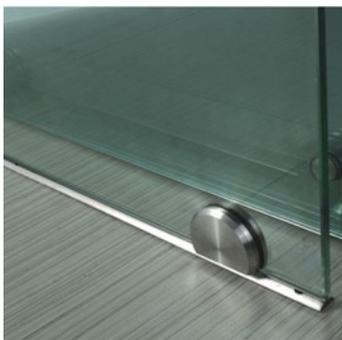
Die Hauptlast des Glases wird bei der Schiebetür Tenuta von den stabilen Bodenrollen aus Edelstahl getragen. Durch dieses Prinzip ist das Schiebetürsystem Tenuta auch für Leichtbauwände, beispielsweise aus Rigips, geeignet.
