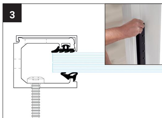
Drücken Sie die Dichtung mit der größeren Lippe ins Profil gerichtet in die vorgesehene Nut. Die Zähne des Dichtungsprofils müssen dabei ins Klemmprofil zeigen.
