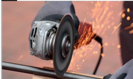
Schneiden Sie die Gewindestangen auf die benötigte Länge zu.
